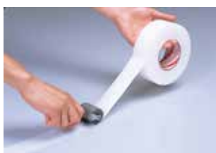
① 保護シートがテープ本体の外側にある状態 (出荷時の状態) でテープを巻きだします。保護シートがついたままの状態です。ローラー、スクイジー等で空気を押し出しながら貼り付け、圧着します。
